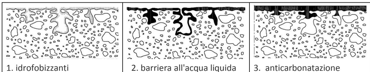
I protettivi idrofobizzanti e traspiranti, impediscono il ristagno d'acqua nel calcestruzzo che è intrinsecamente idrofilo. Il rivestimento non oppone resistenza al passaggio del vapore d'acqua consentendo l'allontanamento dell'acqua assorbita. In tale classe rientrano i rivestimenti decorativi per interni o facciate.
